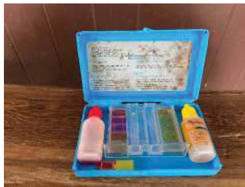
ภาพที่ 3.5.4-1 วิธีการตรวจวัด pH และ Free Chlorine
