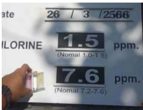
ภาพที่ 3.5.4-1 วิธีการตรวจวัด pH และ Free Chlorine
